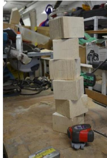
**Dann die Holzdübel einleimen und die entsprechenden Würfel zu einer Länge von 3 Stk. Würfel zusammenfügen.**
