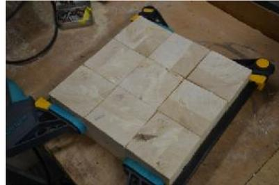
**Es empfiehlt sich, immer nur drei Blöcke zusammenzuleimen, weil sonst schwierig wird, alle entstandenen Quadrate mittels Zwinge oder Spanngurt zusammenzuziehen!**
