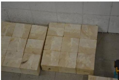
**Anschließend die linken und die rechten Blöcke zusammenleimen, gut spannen und trocknen lassen!**
